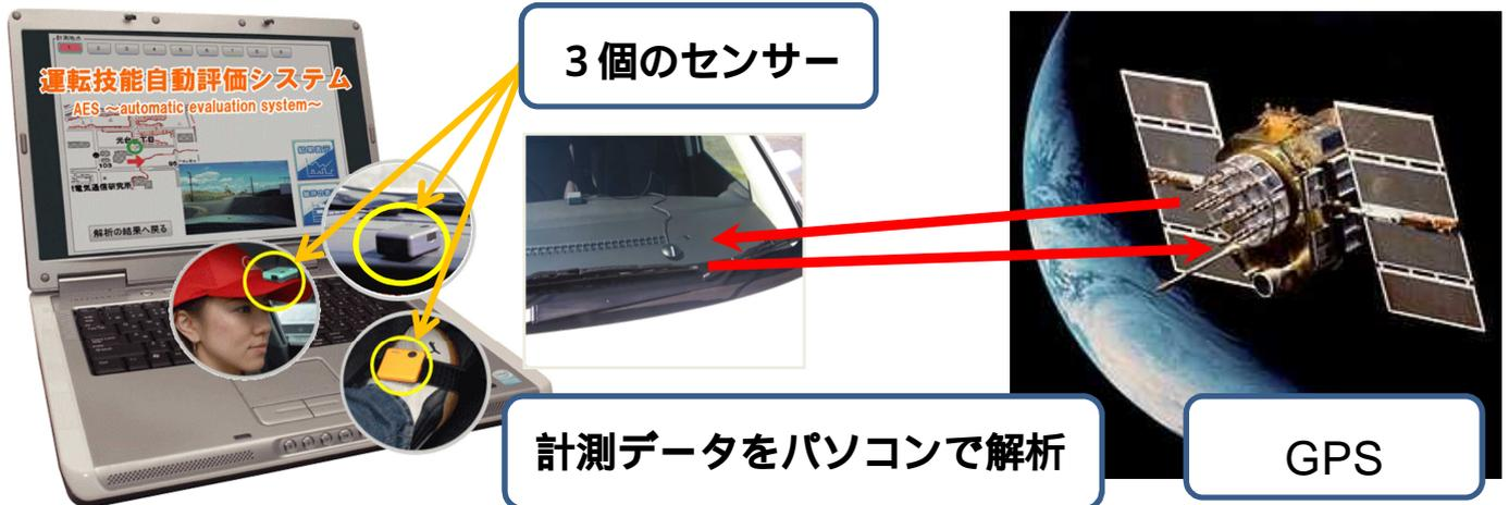
センサーとGPSで計測したデータをコンピューターで解析して運転技能の欠点・クセをグラフ化したデータで確認し、そのデータを見ながら、今後の運転についてアドバイスを行います。
